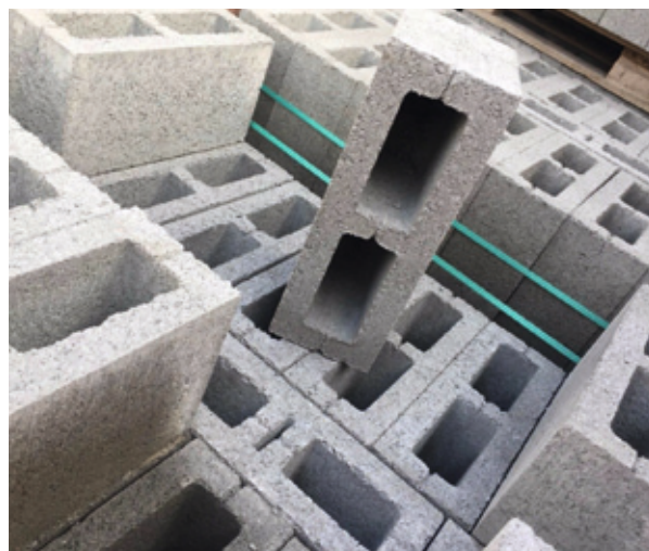
Leichtbeton-Hohlblöcke für die Verwendung im Mauerwerksbau
